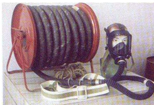
Спуск людей в колодцы допускается только в шланговом противогазе. Обычно эту операцию выполняют трое рабочих, обеспеченных предохранительным поясом и страховочной веревкой.
